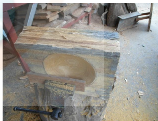
圖 4-48 用氣動式雕刻刀挖出碗的粗胚(研究者拍攝, 2014)
