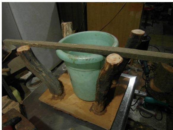
圖 4-17 用垃圾桶輔助切割椅腳(研究者拍攝, 2014)
