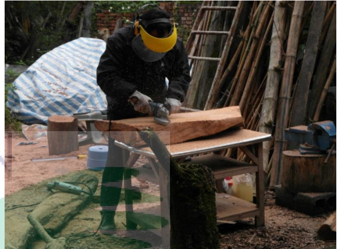
圖 3-1 處理漂流木表面的工具—砂輪機和磨片(研究者攝，2014) 圖 3-2 戴防護裝備的研究者，2014
