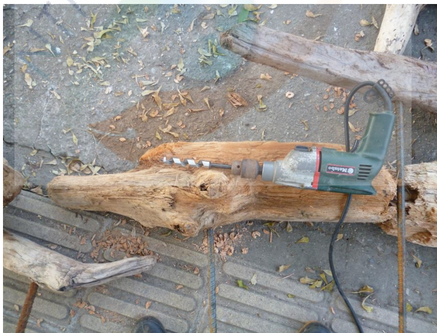
圖 4-58 用電鑽把海邊撿來的漂流木打洞並插入鋼筋(研究者拍攝，2014)
