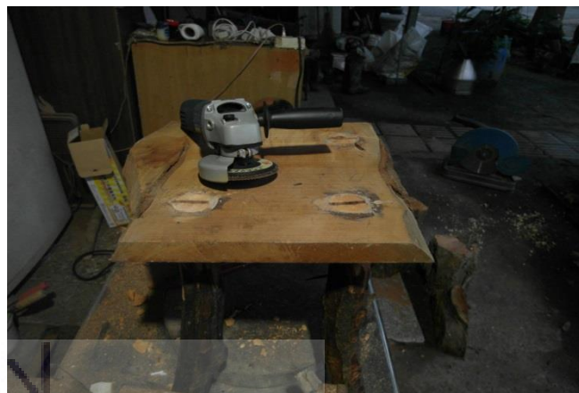
圖 4-14 用砂輪機磨平椅面(研究者拍攝, 2014)
