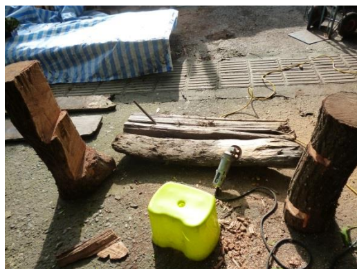
圖 4-32 用砂輪機修飾平面與凹槽 (研究者拍攝，2014)
