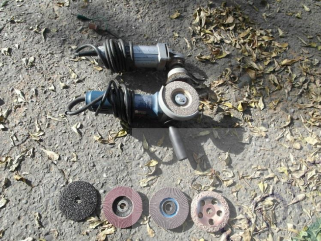
圖 3-1 處理漂流木表面的工具—砂輪機和磨片(研究者攝，2014) 圖 3-2 戴防護裝備的研究者，2014
