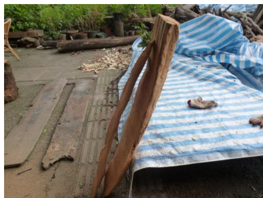
圖 4-33 用鏈鋸裁出弧形板材 (研究者拍攝，2014)
