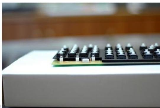
圖2-8-3 最上方為軸，中間為鐵板，最下方為PCB板
