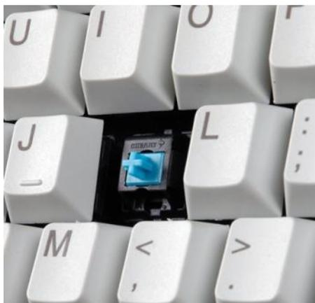
圖2-8-2 機械式鍵盤，只要將鍵帽拔下，就可以看到軸了
