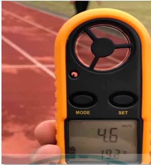
圖 15 液晶螢幕顯示的風力級數風速氣溫
