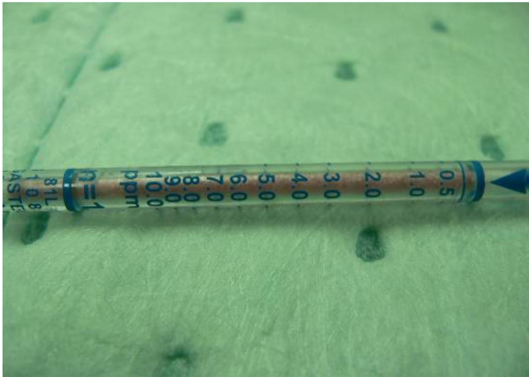
圖八、檢知管細部圖：依照變色程度對照刻度，來判別所偵測的氣體
