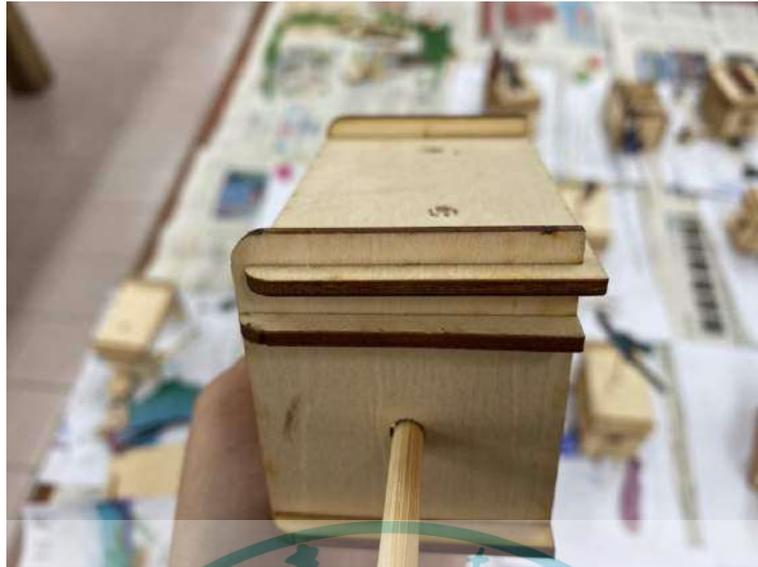
圖 54 孔洞鑽在偏離中心軸的位置
